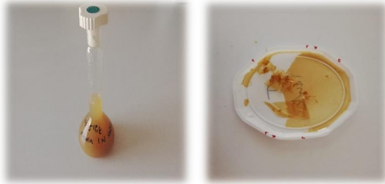
Şekil 4. 1 N NaOH'ta kazein çözünürlüğü ve film oluşumu.
