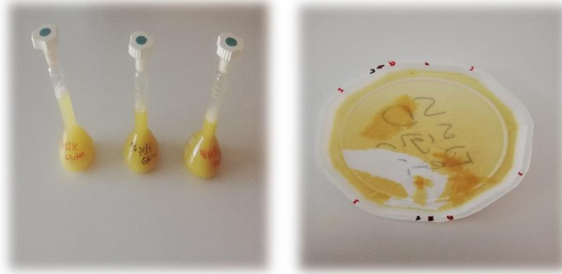
Şekil 8. %95'lik etanol+ 1 N NaOH'te glutenin çözündürülmesi ve film oluşumu.
