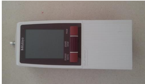
Şekil 1. Yüzey pürüzlülüğü cihazı (Mitutoyo SurfTest SJ-210)
