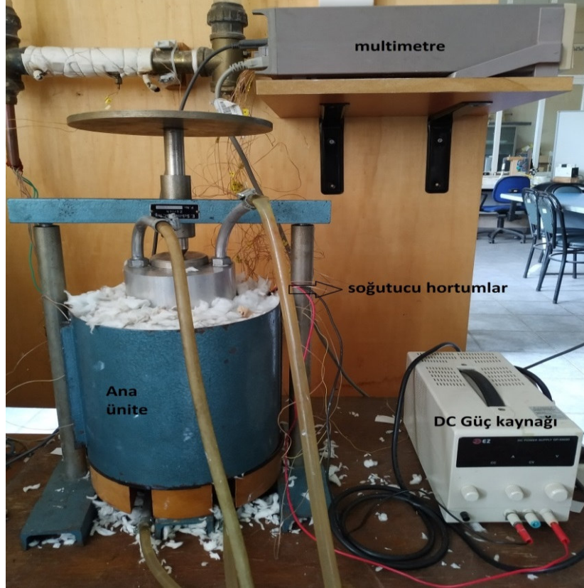
Şekil 3: Isı iletim katsayısının ölçülmesi için oluşturulmuş test düzeneği
