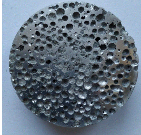
Şekil 1: Sintaktik Köpük Metaller ve içyapı görüntüleri
