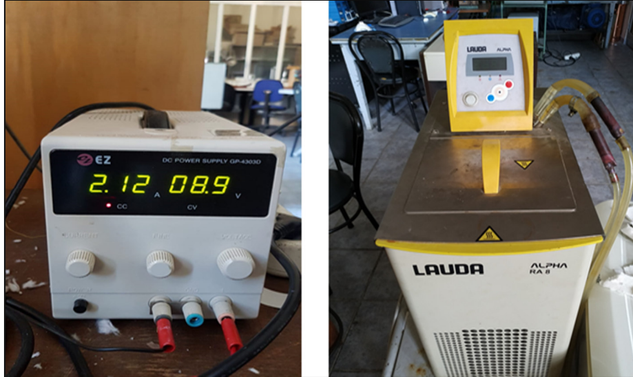
Şekil 14: DC güç kaynağı ve Lauda Alpha marka soğutucu ünite
