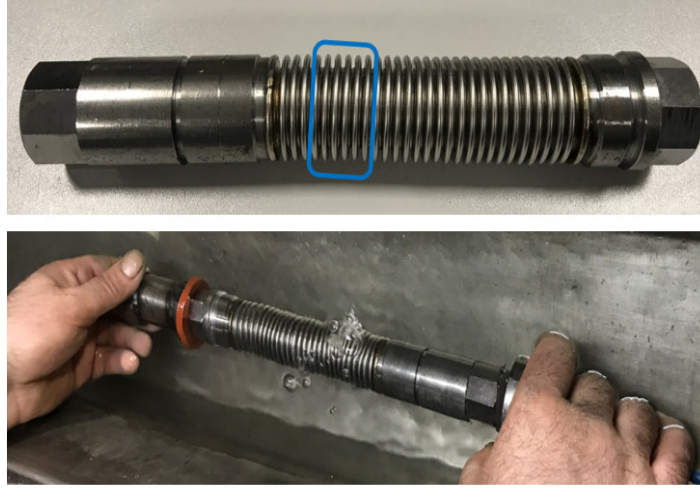
Şekil 13: Yorulma testi sonrası oluşan hasar bölgesi.
