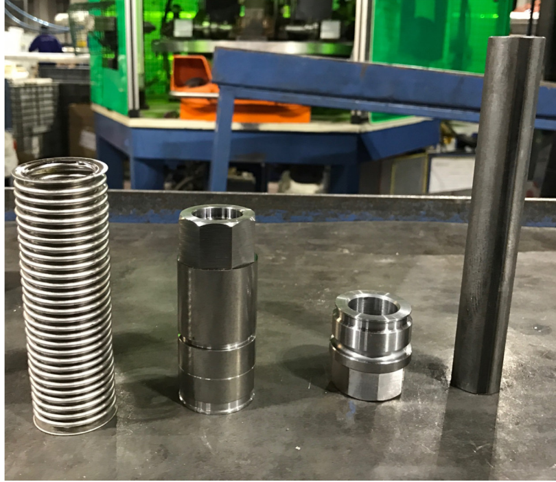
Şekil 3: Kompansatörü oluşturan elemanlar
