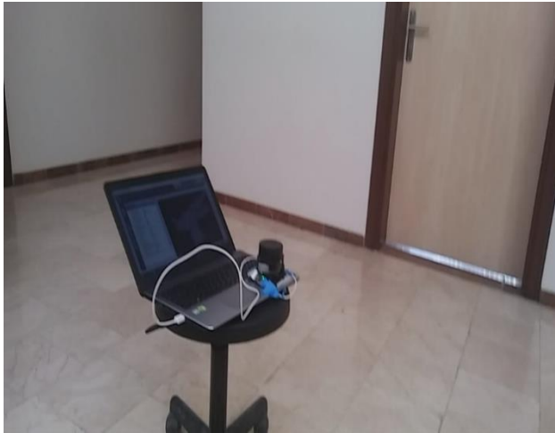
Şekil 1. RPLIDAR 360 ° lazer tarayıcı cihazı kullanılarak laboratuvar ortamının haritasının çıkarılması
